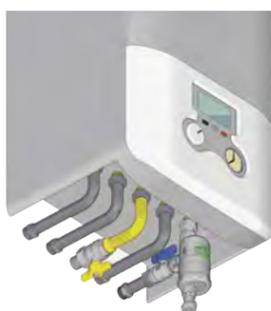
**1. ESEMPIO** di installazione con valvola di arresto sulla tubazione di ritorno.
