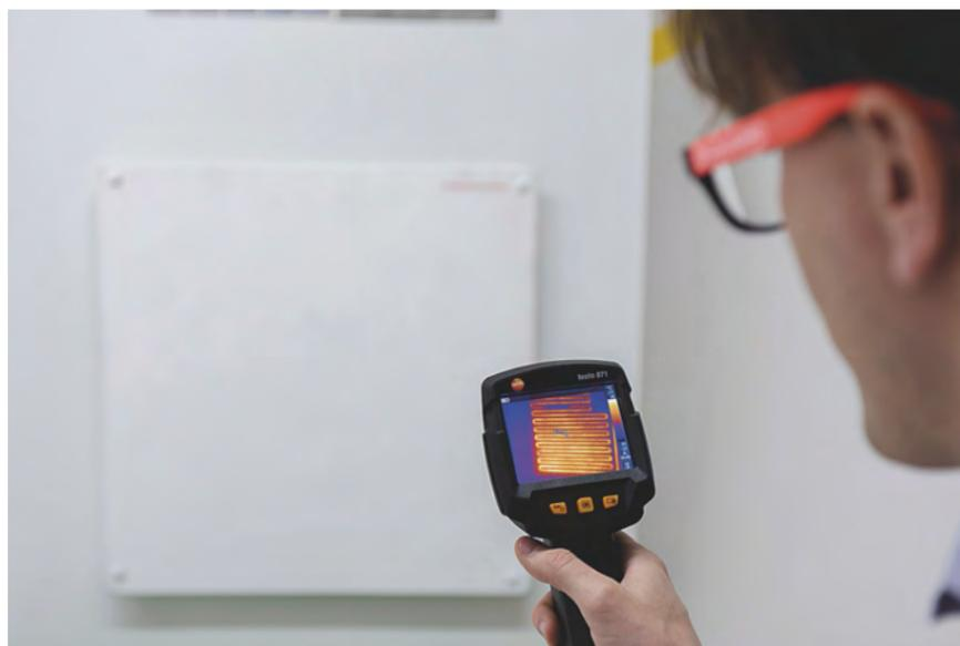
2. **MANUTENZIONE.** Una delle applicazioni tipiche è la ricerca di guasti in circuiti idraulici e serpentine.
