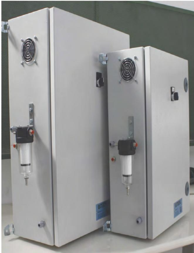
**SATELLITI DI ANALISI** della combustione ed emissione da connettersi alle due centrali di gestione possibili.
