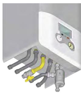
**2. ESEMPIO** di installazione sulla tubazione di ritorno con uno scambio nell'ordine di connessione.
