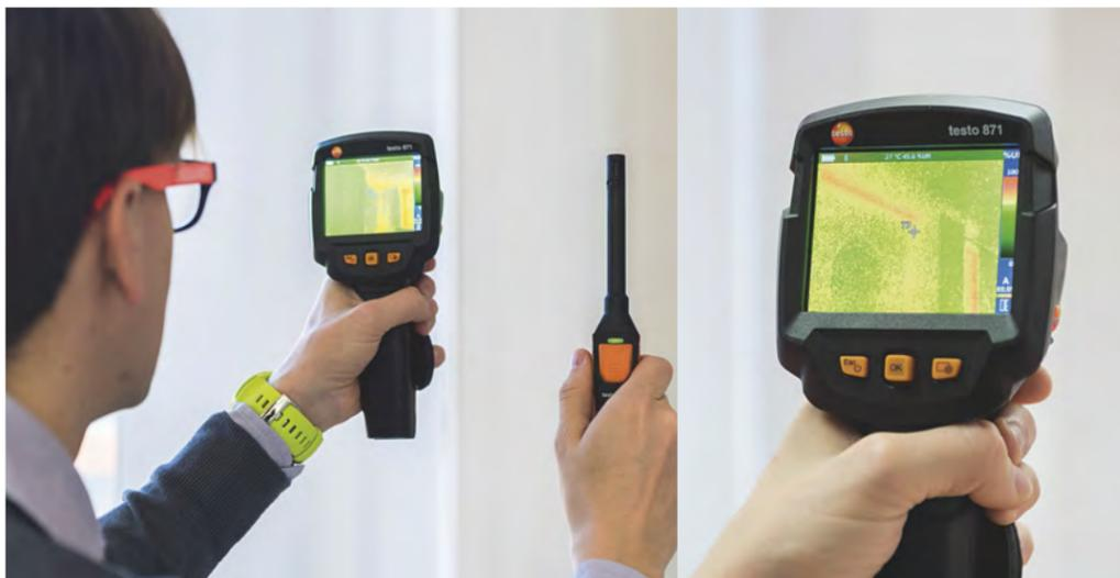
5. **USANDO LA TERMOCAMERA** e il termoisometro testo 605i (serie Smart Probes), si evidenziano le aree tendenti al rosso (soggette a umidità da condensa) e quelle verdi (basso tasso di umidità).
