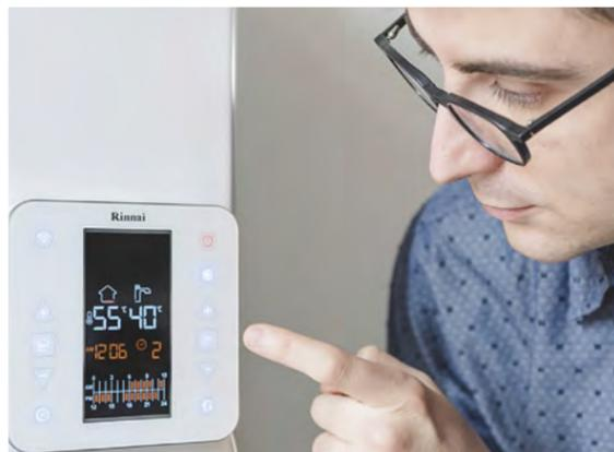
**11. DOPO AVER** ricollegato l'alimentazione elettrica della caldaia Mirai, accendere il comando Wi-Fi premendo il tasto "on".
